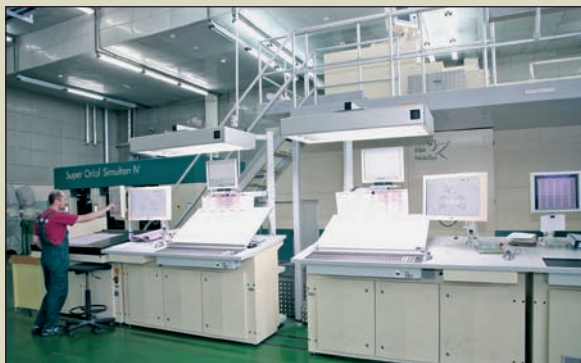
Змонтована і введена в експлуатацію одна з трьох нових аркушевих машин орловського офсетного друку "Супер Орлов симулан IV" (Super Orlof Simultan IV) останнього покоління — ексклюзивна розробка для України.
