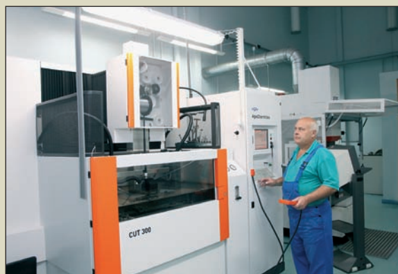
Вирізний верстат електроіскрової обробки фірми “Ажі Шарміль” (GF Agie Charmilles) дротом, тоншим за людську волосину, здатний вирізати філігранні фігури в металі завтовшки до 250 мм. Можливості цього верстата широко використовуються під час виготовлення карбувальних кілець у монетному виробництві та штампів для вирубування заготовок орденів і медалей.
