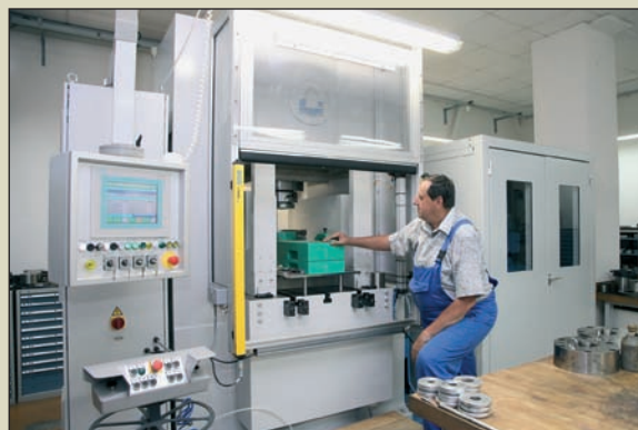
Гідравлічний прес фірми “Зак енд Кіссельбах” (Sack & Kiesselbach Maschinenfabrik GmbH) тиском зусиллям у 2,5 тисячі тонн переносить зображення з редуційного пуансона на карбувальний інструмент для виготовлення монет великих діаметрів. Для монет менших розмірів тиск варіюється від 630 до 1 250 тонн.
