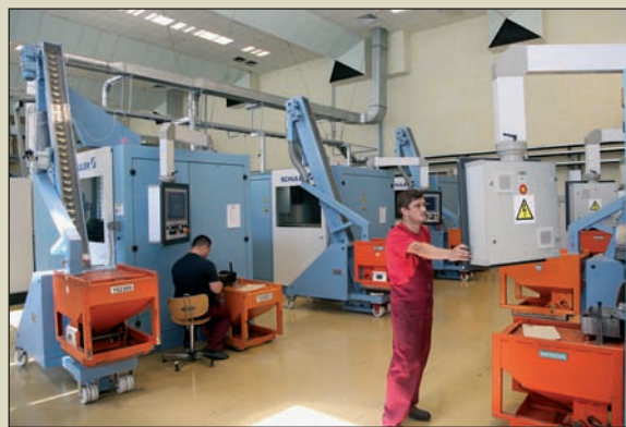
У цеху карбування розмінних та обігових монет оновлено парк обладнання: встановлено 10 нових високошвидкісних сучасних карбувальних прес-автоматів “Гребенер” (Grabener) вертикального карбування і 6 — “Шулер” (Schuler) горизонтального карбування. Преси створюють тиск 150 тонн, швидкість карбування залежить від діаметра заготовок і в середньому становить 550 штук за хвилину.
