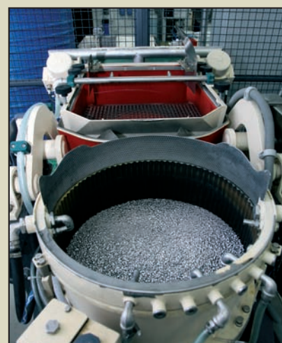
Установка фірми "Рослер" (Rösler) для полірування заготовок пам'ятних монет із дорогоцінних і недорогоцінних металів. Заготовки завантажують у спеціальний барабан, наповнений кульками з нержавіючої сталі та спеціальними розчинами, і полірують упродовж 15–20 хвилин.
