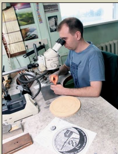
Зображення на пам'ятній монеті повинно точно відповідати ескізу та гіпсовій моделі. Завдання гравера — довести до бездоганного вигляду редуційний пуансон, з якого виготовлятиметься карбувальний інструмент.
