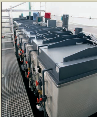
Завершується монтаж гальванічної лінії твердого хрому. Карбувальні штемплі для виготовлення пам'ятних монет потребують покриття гальванічним способом шаром твердого хрому, який надає їм необхідної твердості й стійкості.
