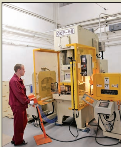
Вирубний прес із силою натискання 60 тонн, на якому виготовляють заготовки для пам'ятних монет із недорогоцінних металів і сплавів. Новий верстат виготовляє заготовки з нейзильберу діаметром 31.0 мм і 35.0 мм, завдяки чому вдалося відмовитися від закупівлі відповідних заготовок за кордоном.
